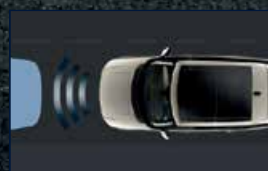
Piloto automático adaptativo com sistema automático de frenagem
